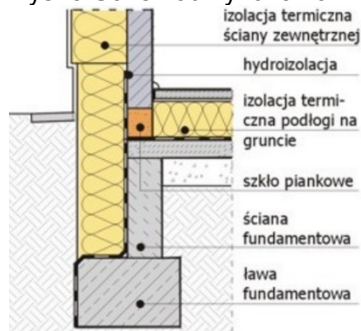
Rys. 3 Schemat wykonania izolacji przeciwwilgociowej typu średniego.
