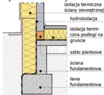
Rys. 3 Schemat wykonania izolacji przeciwwilgociowej typu średniego.
